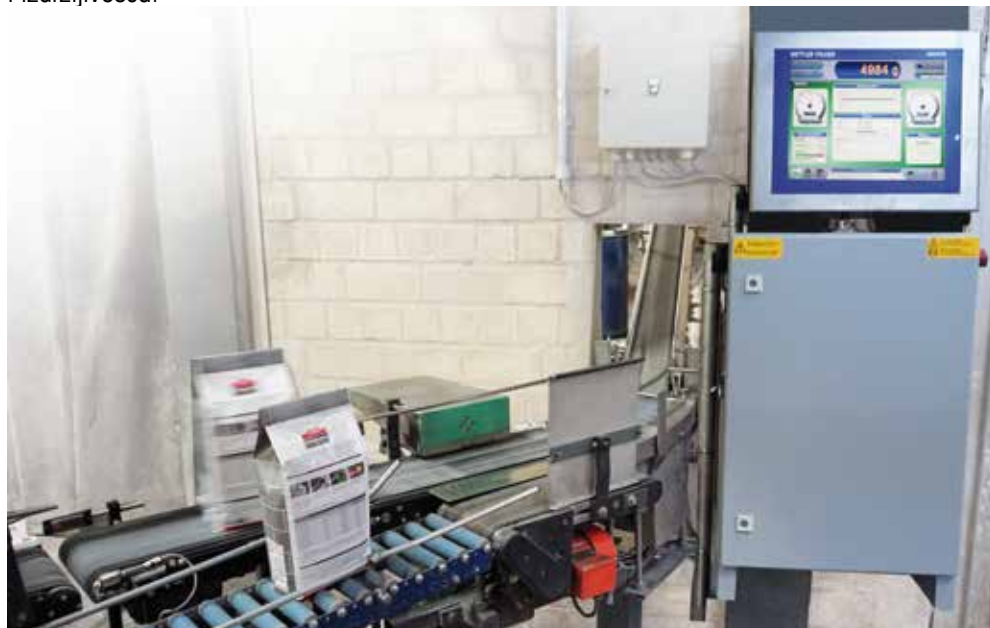
Vaganje uspravnih vreća pomoću kontrolne vage XS40
